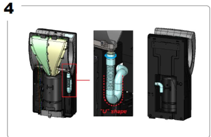
Confirme se o tubo mantém a forma em "U" e ligue à rede de esgoto. Finalmente, monte a carcaça frontal do secador.
