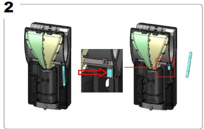
Desmonte a carcaça frontal do secador e corte a mangueira que faz ligação ao depósito/reservatório de água, rasando pela peça de plástico, como mostra o pormenor da imagem. Encaixe este pedaço de mangueira ao novo tubo fornecido.
