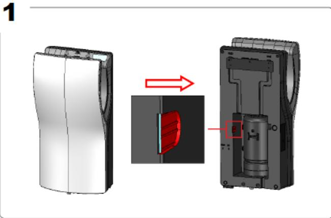
Quebre a patilha situada na parte traseira (zona lateral interior) do secador com a ajuda de uma chave de fendas e um martelo para facilitar a operação.
