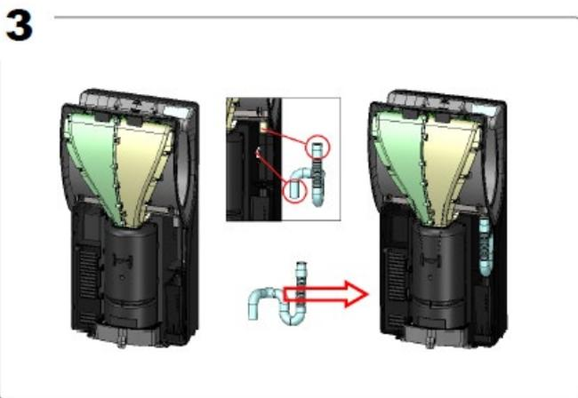
Introduza o novo tubo fornecido já com a mangueira excedente encaixada no mesmo, pelo orifício que fez na parte traseira do secador (onde quebrou a patilha). E encaixe na parte da frente onde cortou a mangueira.
